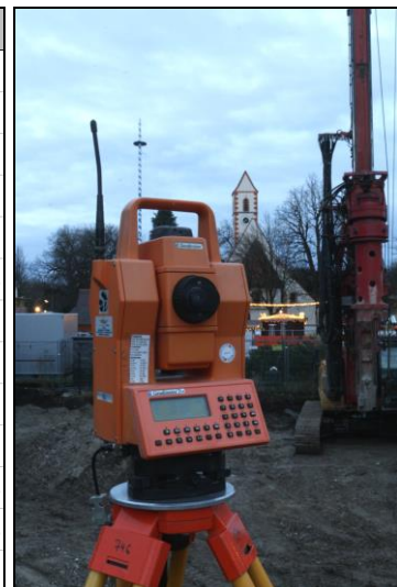
Abb. 15 Links: Festpunkt (FP) und Anschlusspunkte (AP) der Grabung. Rechts: Totalstation Geodimeter 600 DR.
