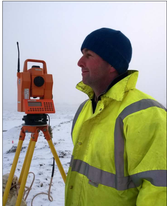
Abb. 13 Links: Fest- (FP) und Anschlusspunkte (AP) der Grabung. Rechts: Aufmaß des Planums mittels Totalstation.
