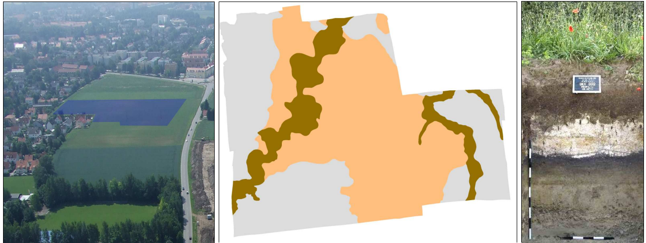
Abb. 3 Links: Luftbild nach Süden; Fläche BP 171 II blau einschraffiert (Bildautor: Axel Kowalski 2006). Mitte: Aufschlüsse unter Humus im Bereich des Bebauungsplanes 171 II (genordet). Hellgrau: Alm; gelb: Lehm; grünlich: mit Kolluvium verfüllte Mäander. Rechts: Geoprofil der nördlichen Nachbargrabung M-2010-2213-1 (BP 171 I).
