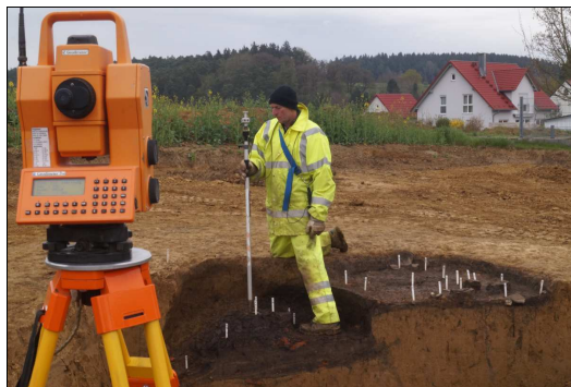
Abb. 8 Links: Vermessung mit Totalstation. Rechts: Anschlusspunkte der Grabung.
