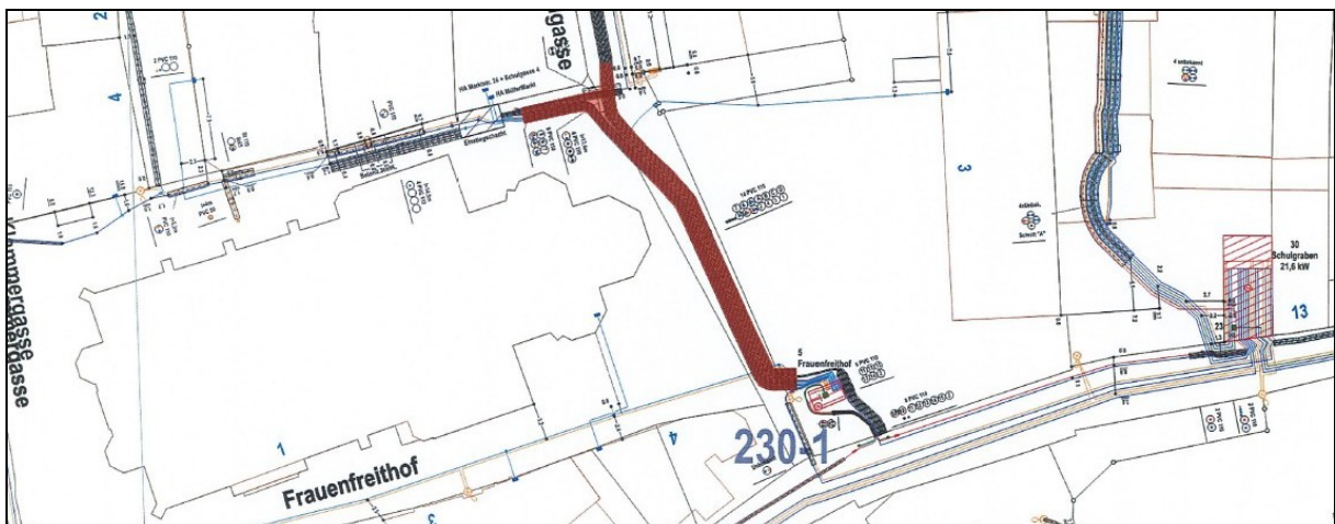
Abb. 2 Spartenplan. Leerrohrtrasse braun schraffiert (© Stadtwerke Bad Tölz 2025).
